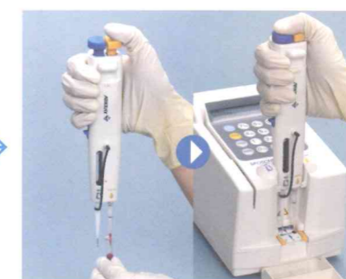
二連ピペットで検体と参照液を吸引し、 本体に挿入して点着します ※写真は二連ピペットIIであるため、測定のと びごとに参照液吸引の必要はありません
