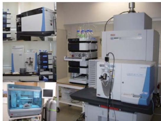
図1. プロテオミクス関連機器。超高分解能フーリエ変換型質量分析計(右)、Orbitrap Fusion(左上)、Q-Exactive(左中)、試料処理ロボット(右下)。
